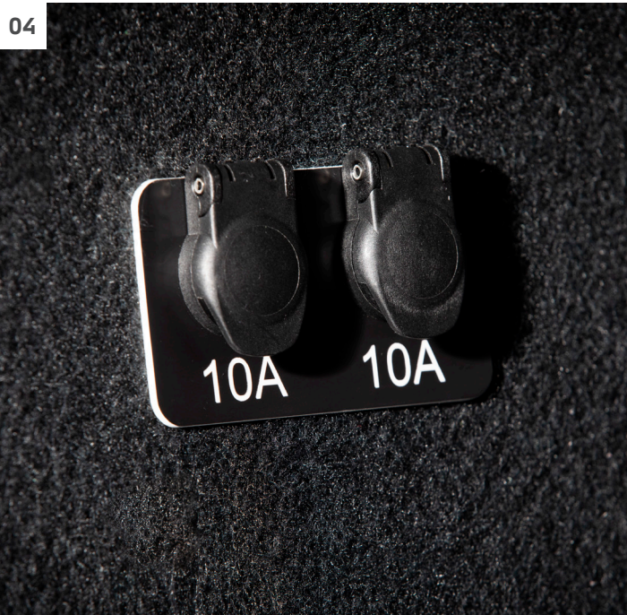
[ 01 ] Schaltzentrum für Sondersignalanlage und Bedienteilanordnung für Funkvorbereitung Motorola MRT. [ 02 ] Schaltzentrum BMW 5er mit 12 Tasten. [ 03 ] Dachbalken Hänsch DBS 4000 mit offener TETRA Antenne. [ 04 ] 2 x 12-Volt-Steckdosen nach DIN 4165 im Gepäckraum.
