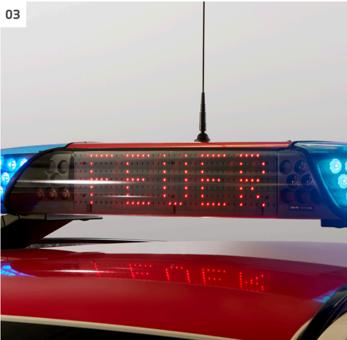
[ 01 ] Schaltzentrum für Sondersignalanlage und Bedienteilanordnung für Funkvorbereitung Motorola MRT. [ 02 ] Schaltzentrum BMW 5er mit 12 Tasten. [ 03 ] Dachbalken Hänsch DBS 4000 mit offener TETRA Antenne. [ 04 ] 2 x 12-Volt-Steckdosen nach DIN 4165 im Gepäckraum.
