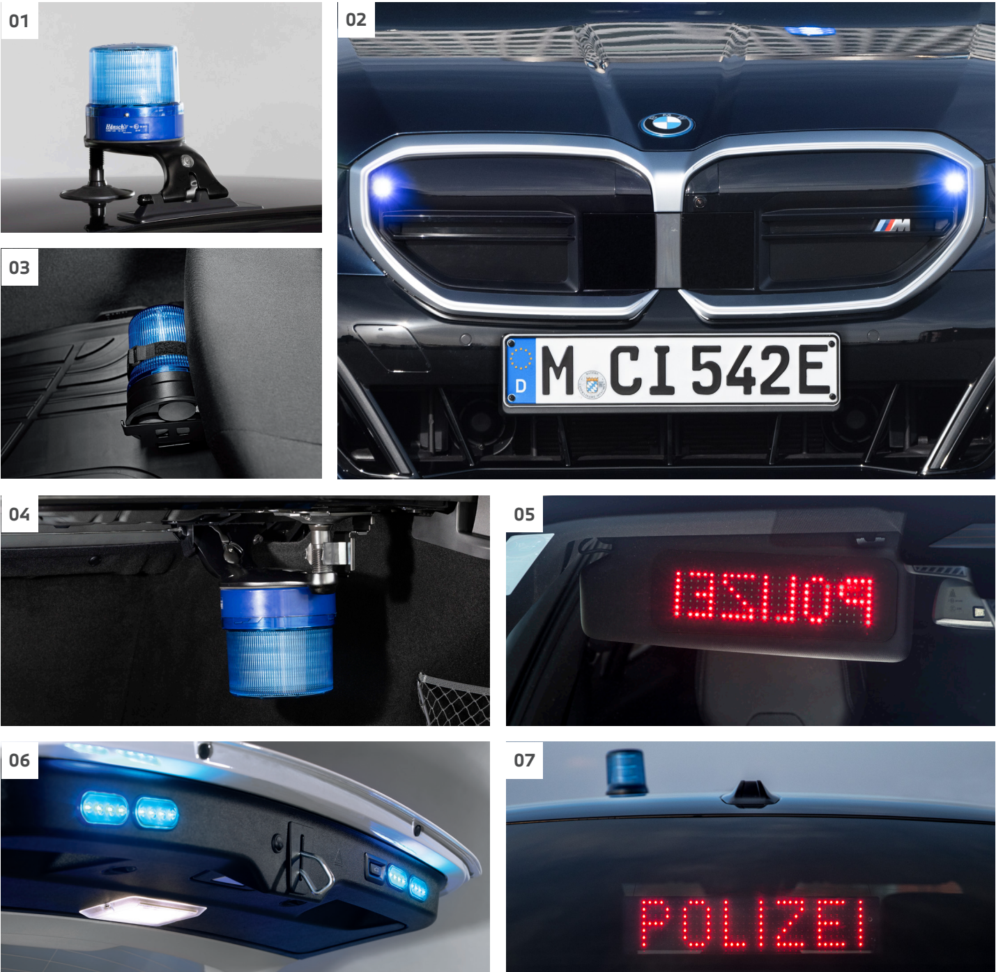
[ 01 ] Rundumkennleuchte Comet auf Fahrzeugdach. [ 02 ] Werksverbaute Frontblitzer hinter BMW Niere. [ 03 ] Werksverbaute Magnetblitzleuchte Movia SL mit Halter am Fahrersitz (Abb. BMW 5er). [ 04 ] Aufnahme Rundumkennleuchte Comet im Kofferraum. [ 05 ] Anhaltesignalgeber, vorn in der Sonnenblende integriert. [ 06 ] Heckblitzer, in Heckklappe integriert. [ 07 ] Anhaltesignalgeber hinten auf der Hutablage.
