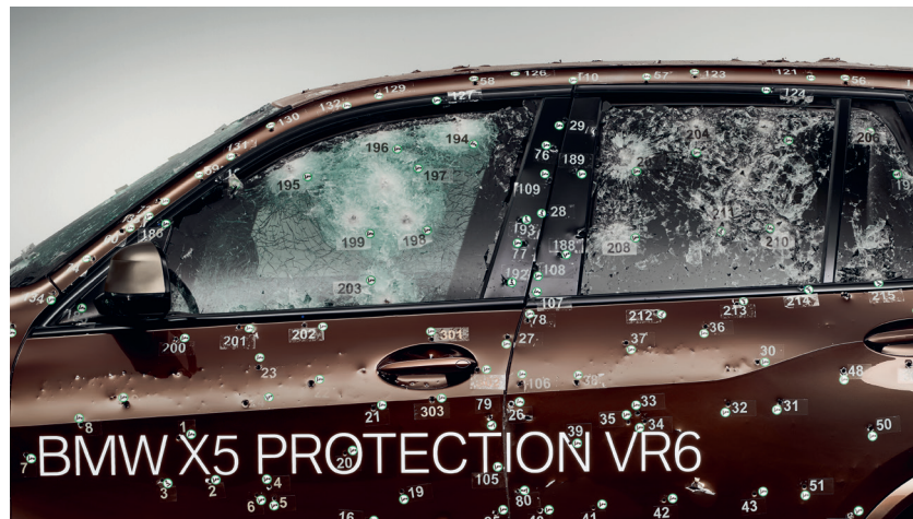
Mehrlagen-Sicherheitsglas: Fahrer und Passagiere des neuen BMW X5 Protection VR6 werden durch ein etwa 30 mm starkes Mehrlagen-Sicherheitsglas mit innen liegender Polycarbonat-Splitterschutzschicht geschützt.(2)
