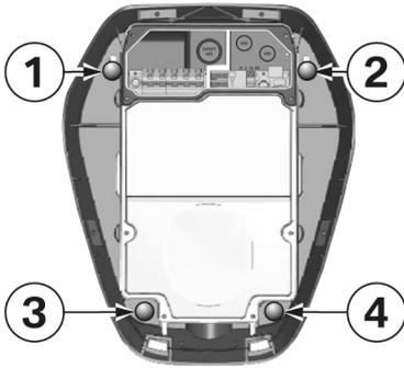
1. Hängen Sie nach der Kabeleinführung die Wallbox auf die zwei oberen Tellerkopfschrauben **1** und **2** ein.
