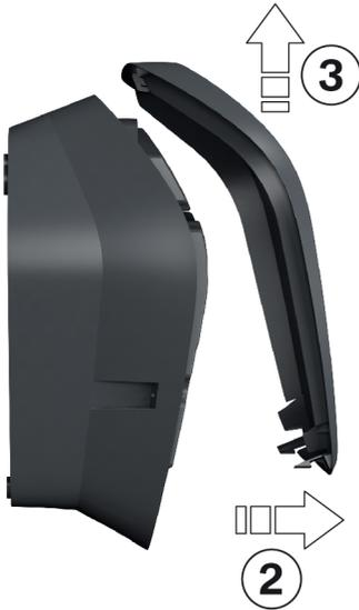
2. Schwenken Sie die Gehäuseabdeckung an der Unterseite ein Stück nach vorne **2**.
