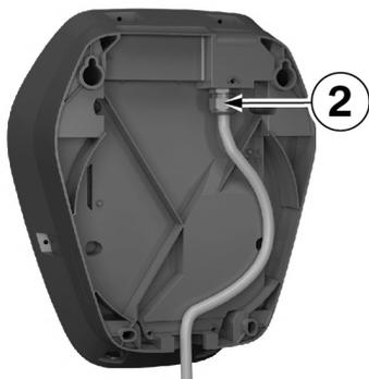
1. Verlegen Sie die Versorgungsleitung in einer Schlaufe zur Kabelverschraubung **2**. Beachten Sie die zulässigen Biegeradien des Kabels.
