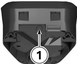
Die Anschlusskabel können von oben durch die Gehäuseöffnung im Außenrahmen eingeführt werden.
