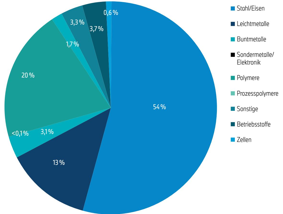
Abb. 2: Werkstoffzusammensetzung des BMW X2 sDrive20i zum Produktionsstart.
