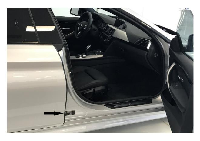
Das Prüfschild ist entweder im Motorraum oder an der B-Säule des Fahrzeuges (Fahrerseite oder Beifahrerseite) angebracht.
