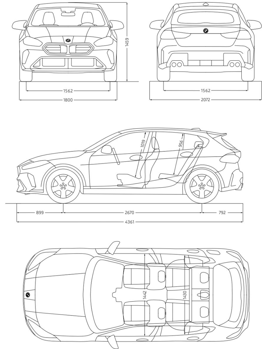
Alle Maßangaben der technischen Zeichnung in Millimeter. Angaben zu Fahrleistung, Verbrauch und CO<sub>2</sub>-Emissionen gelten für Fahrzeuge mit Seriengeräte. Werte in [ ] gelten für Fahrzeuge mit Steptronic Getriebe.
