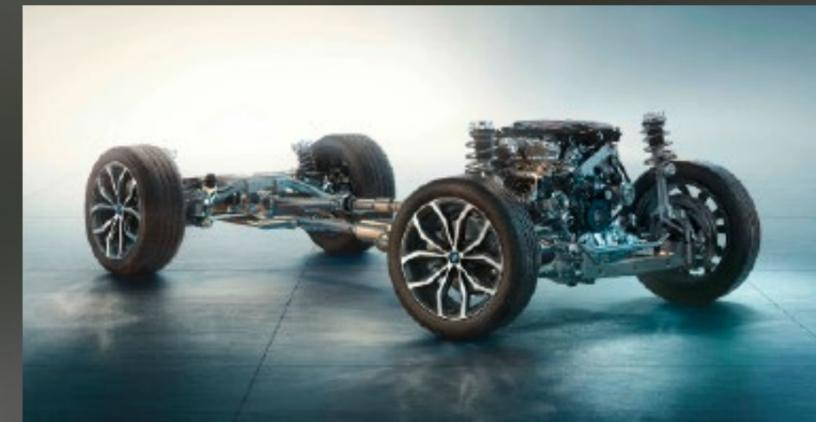
Die Federn des M Sportfahrwerks weisen eine moderat erhöhte Federrate auf, während in erster Linie die zugleich verbauten härteren Fahrwerkstabilisatoren die Wankneigung in Kurven vermindern. Damit sorgt das M Sportfahrwerk für eine deutlich erhöhte Lenkpräzision, ohne übermäßig an Komfort einzubüßen. Perfekt darauf abgestimmt ist die Dämpfung der härteren Stoßdämpfer.
